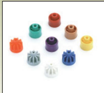
Les buses 10FC illustrées ci-dessus fonctionnent au même débit. À mesure que la pression augmente, les buses en caoutchouc flexible réduisent l'ouverture de l'orifice, assurant un débit constant sur une large plage de pressions.
